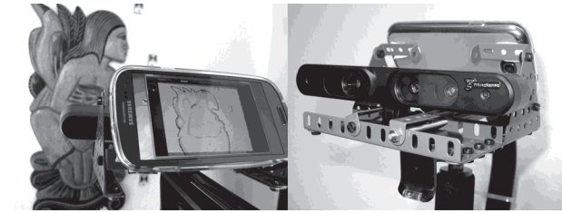
Abbildung 2. Prototyp Kamerahalterung mit Smartphone
